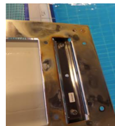
OSB no mantenido apropiadamente
