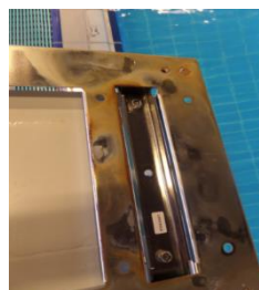
OSB mal entretenu
